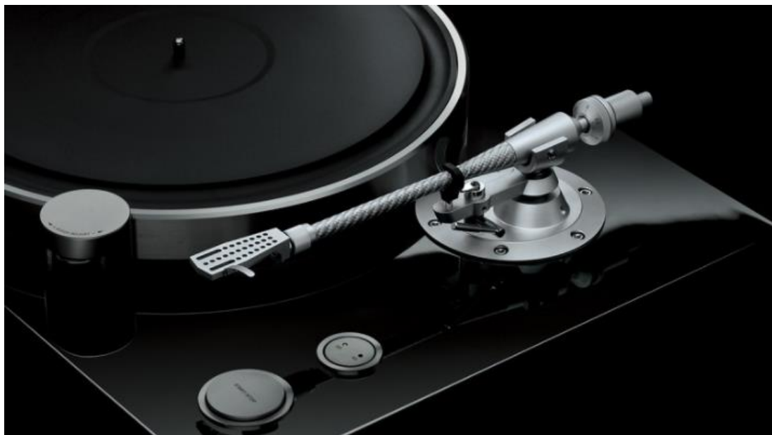
▲由于没有补偿角，所以也不需要抗滑装置，GT-5000 的唱臂不需要调整抗滑，只需要调 VTA（SRA）。
