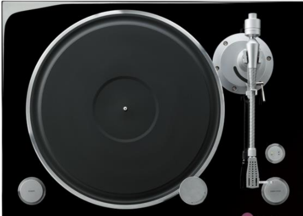
▲GT-5000 的外转盘直径 350mm，比一般转盘直径 300mm 大很多，可以产生良好飞轮效应，帮助稳定转速。
