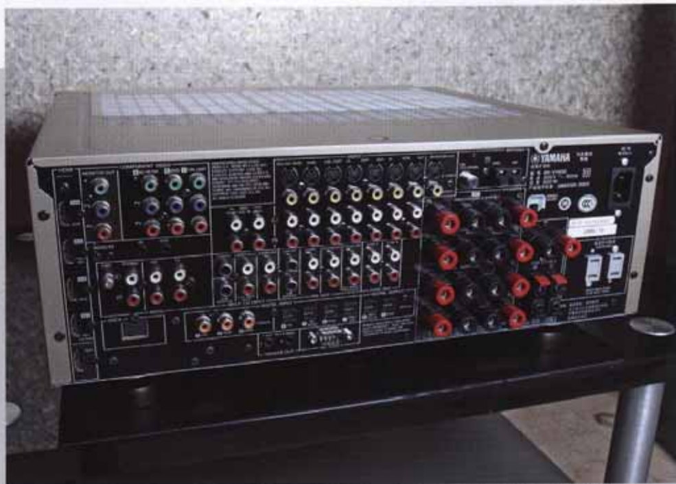
机背备有四进一出1.3a版HDMI端子，支持Dolby Digital Plus、Dolby True HD、DTS-HD完整解码
