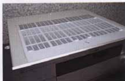
散热窗设计在机箱的顶部
