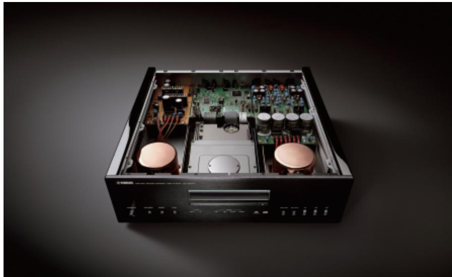
CD-S3000的电源部分采用高品质低漏磁双环形变压器供电，同时结合了分离专用的双线路板，使之从电源开始就完全分离了数字和模拟电路，以消除电源线路的干扰。为了最大限度地降低漏磁于振动所造成的影响，CD-S3000的电源变压器均加设了避震底座及铜皮包围处理。此外，CD-S3000线路的另一大特点是采取了数字/模拟电路板集成电路，将电源变压器和电容器直接安装在各自的数字/模拟电路板上，电路连接摒除了常规的焊接方式，取而代之为直接螺旋式连接，彻底实现了低阻抗的无损连接。
