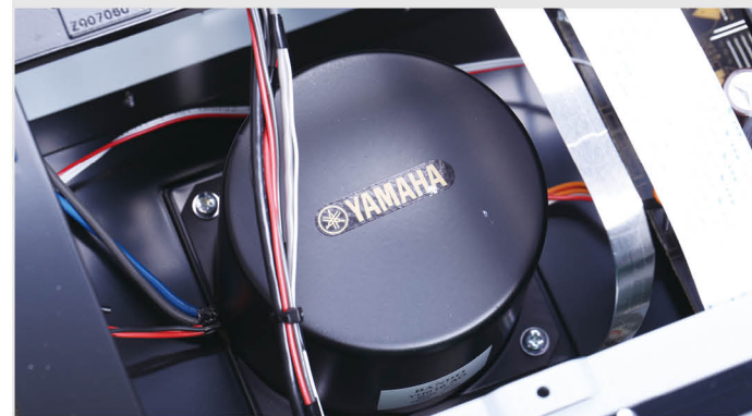
经过屏蔽处理的变压器
