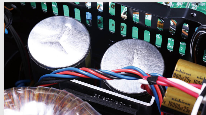
滤波电容由两只27000微法的电容组成
