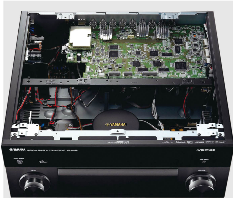
CX-A5100的数据处理部分采用YF-46C6FSW G4和UF-48C7NSW G1芯片，分别用于处理三维音效以及DSP声场处理
