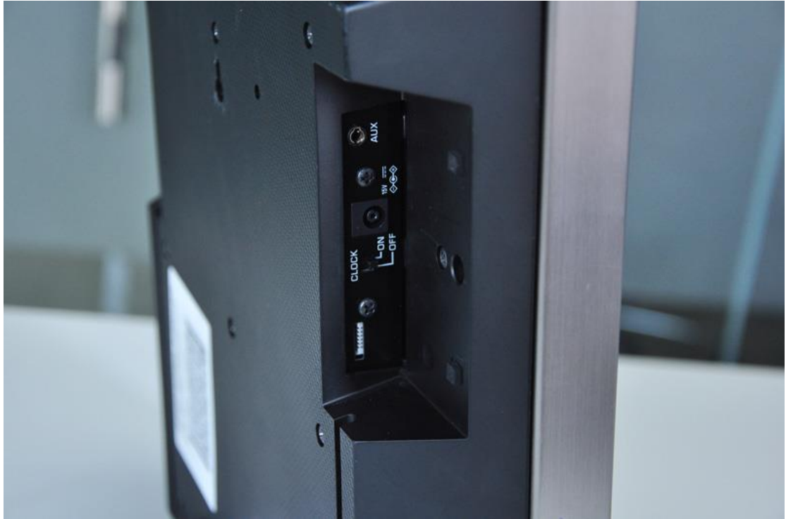
电源插孔位于左侧背面，旁边是 AUX 插孔和 CLOCK 开关。
