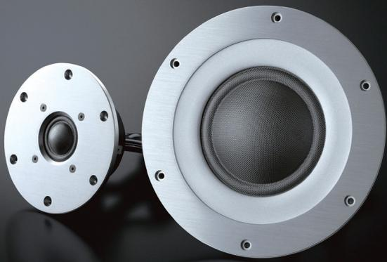
NS-5000 所有单元的振膜都使用 Zylon 化学纤维编织而成，它在刚性与内损之间达到良好平衡，表面再涂上一层 Monel 蒙乃尔合金涂层（含 63% 镍与 31% 铜），有助于表现出管乐器的细腻音色，且可防止 Zylon 因紫外线照射而劣化
