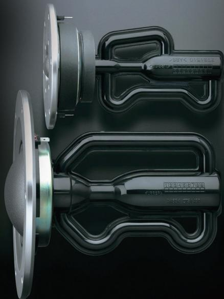
音箱内部的驻波来自单元背波，在箱体内部剧烈扰动，造成无法控制的震动，形成噪音。NS-5000 运用两支箱内有填充材料的 J 型管状物，也就是 Acoustic Absorber 调音器，固定在箱体左、右，可以针对特定频率的驻波加以吸收，如此一来，箱体内就不需要填充过多的吸音材料了
