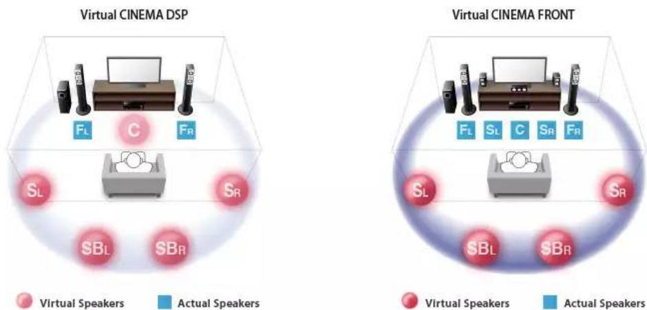
如果你的家中不能够按照家庭影院的方式放置 5 个扬声器, Yamaha 提供了 Cinema Front 的虚拟环绕声技术, 通过这个技术你可以把多个扬声器放在你的电视机前面, 也就是你座位的正前方, 通过这个功能的内部运算, 我们可以让排列在你电视机前面的多个扬声器产生虚拟的环绕声音效, 我们可以感受到内置房间上方和座位后方的声音包围感, 这就是 Yamaha 雄厚的虚拟环绕声技术实力体验。
