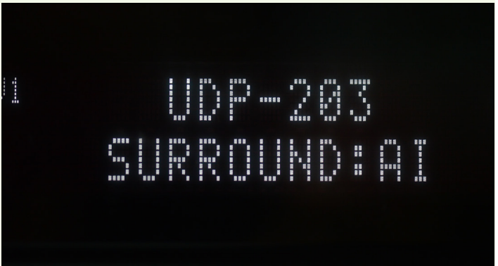
Surround AI是Yamaha AV放大器里面一个新增的功能，通过自动识别播放内容而进行相应的声场处理，可以提高声音的沉浸感
